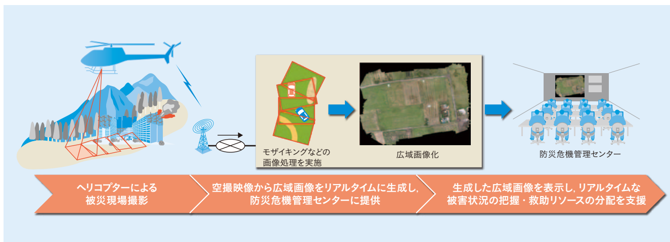
1 リアルタイム空撮映像解析システム
