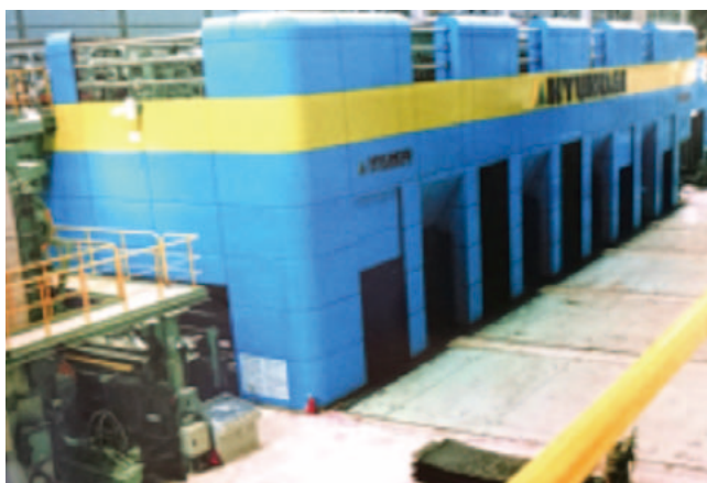
2 韓国Hyundai Steel Company社 冷間圧延設備
