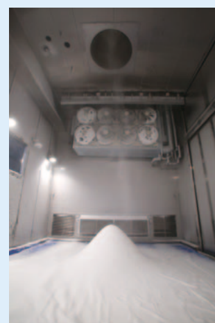
7 日射装置点灯時の様子（上）、降雪装置を連続運転後の試験室内（下）
