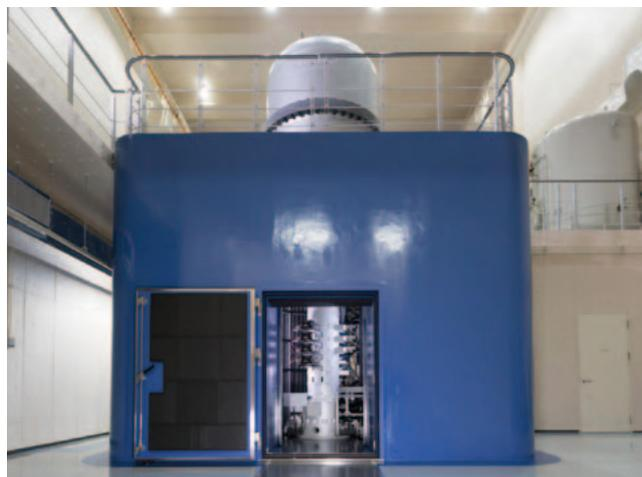
2 原子分解能・ホログラフィー電子顕微鏡
