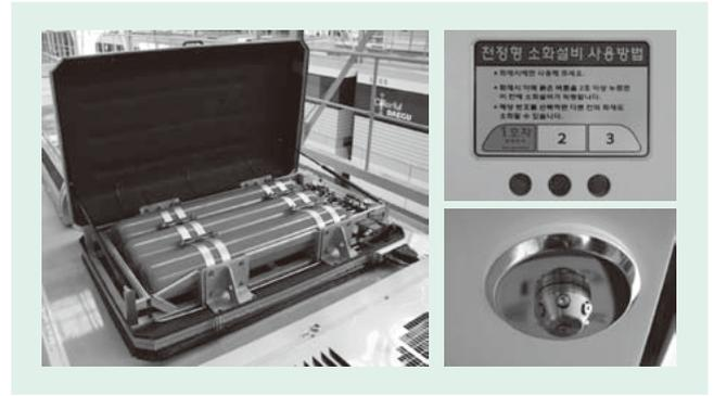
図6 | 車両消火設備
