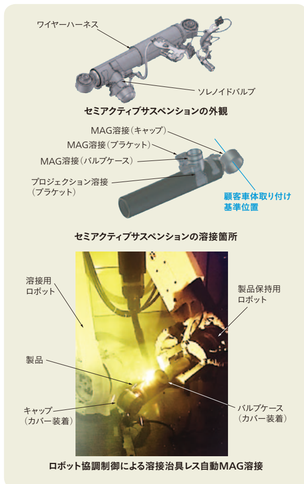
5 ロボット協調制御による溶接治具レス自動MAG溶接
