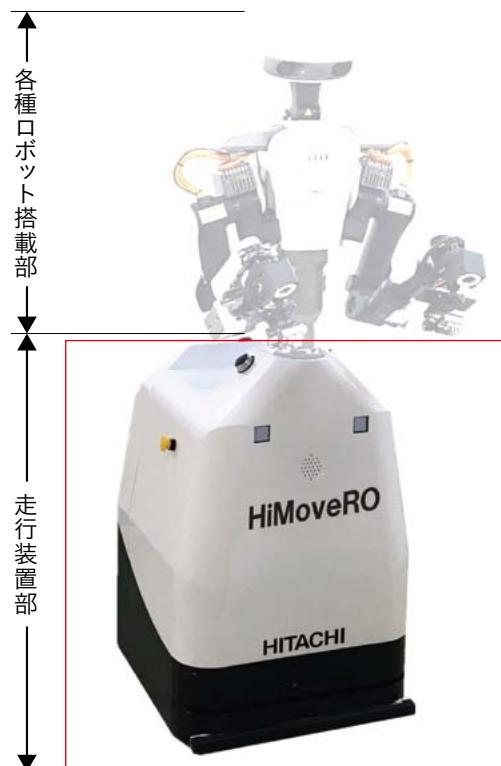
7 カワダロボティクス株式会社製の双腕型ロボットを搭載したHiMoveRO
