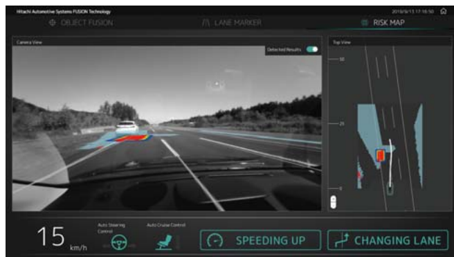
2 リスク予測マップの生成 (左), リスク予測マップを用いた駐車車両回避の自動運転 (右)
