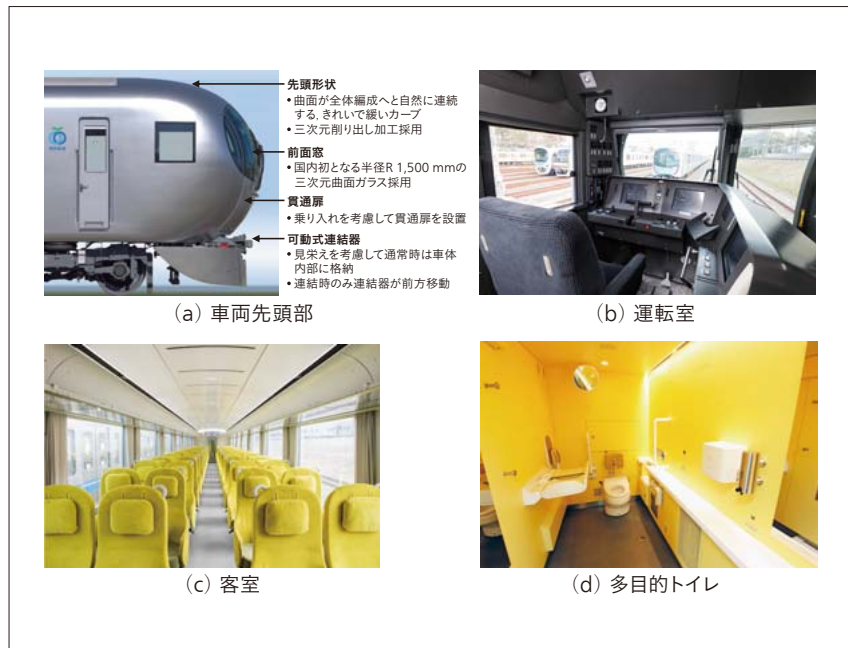
図3 | 車両先頭部の外観および運転室、客室、多目的トイレの内観
