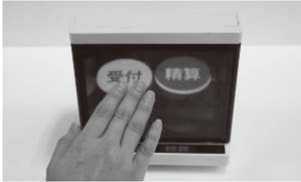
コンパクトタイプの「空中入力装置」に表示したボタンを非接触で操作
