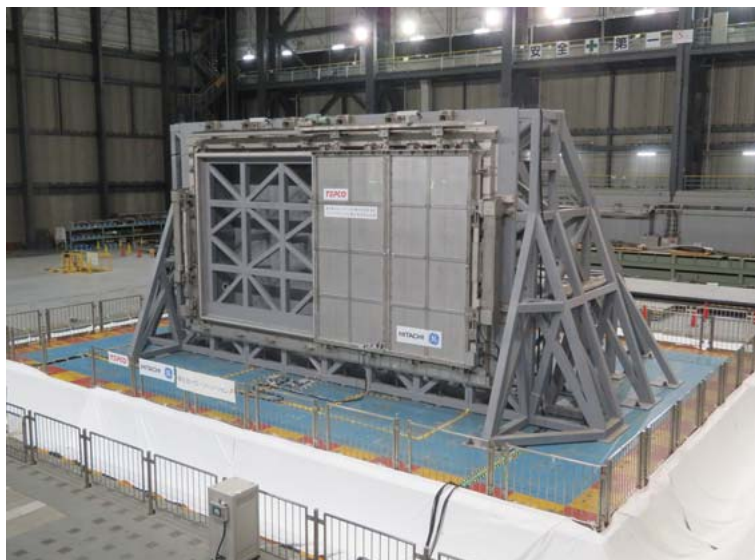
2 ブローアウトパネル閉止装置（スライド型）加振試験状況
