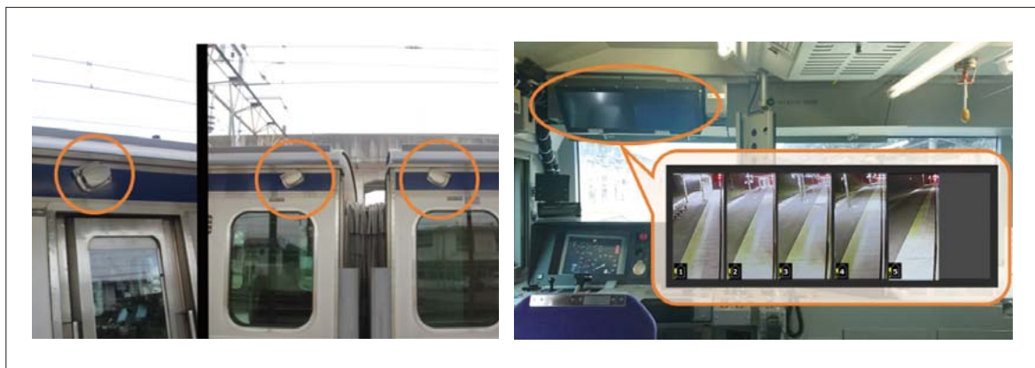
2 車両側面に搭載した車側カメラ（左：先頭車 右：中間車）（左）、運転台に設置したモニタ（映像表示装置、夜間の映像例）（右）
