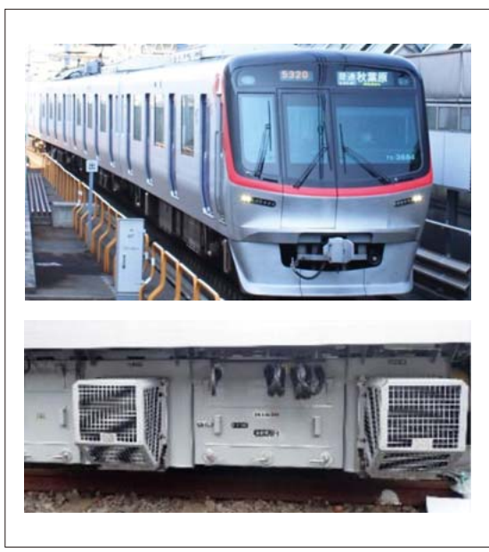
5 TX-3000系車両と主変換装置
