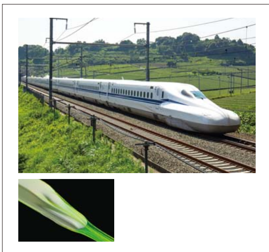
6 JR東海 N700S新幹線車両外観および先頭形状流体抵抗解析結果
