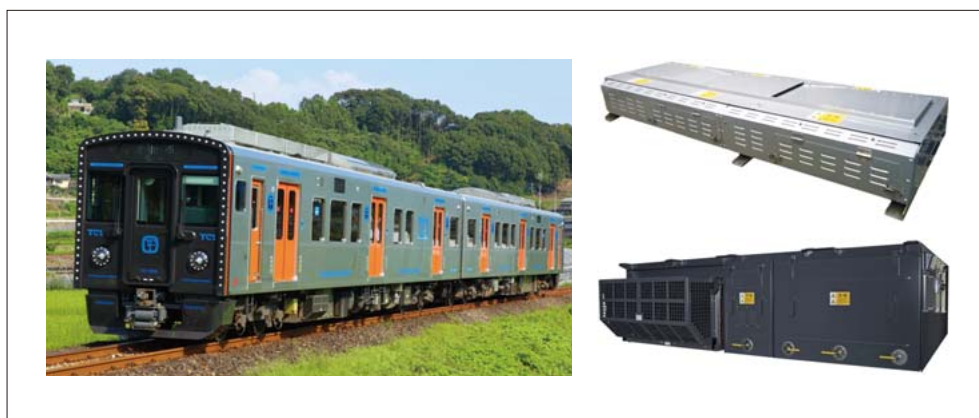
7 JR九州 YC1系ハイブリッド車両の外観(左)、蓄電池(右上)、主変換装置(右下)
