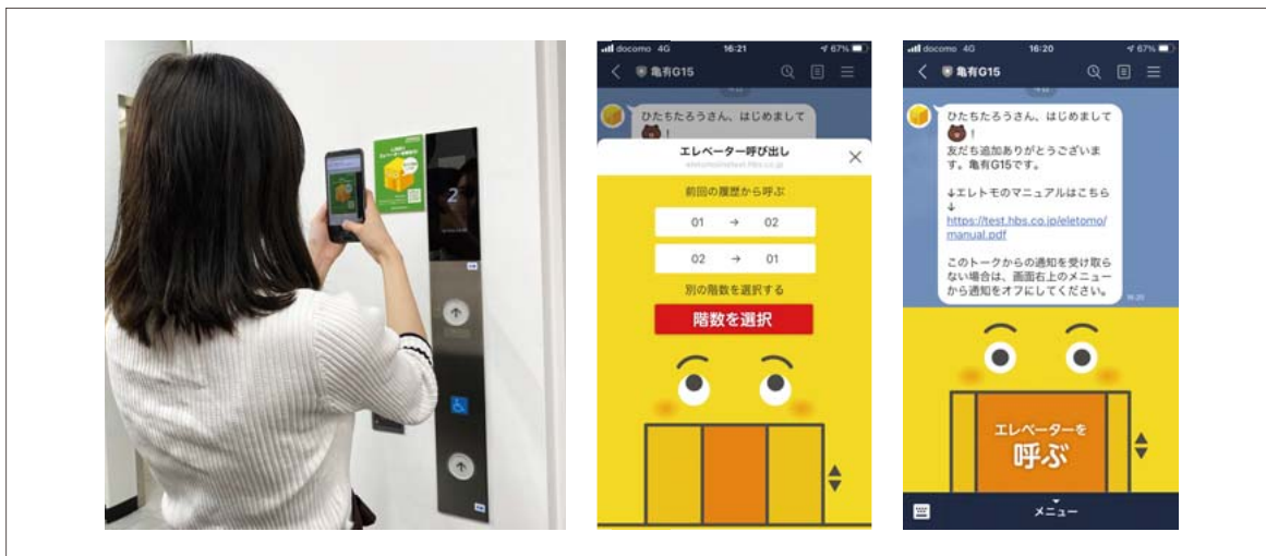
1 LINE連携タッチレスエレベーター呼びサービス画面イメージ
