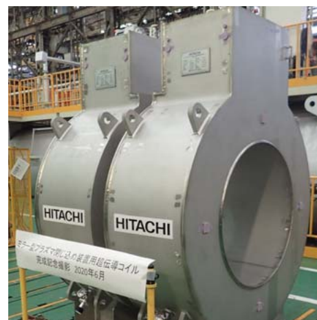
2 大型伝導冷却方式超伝導磁石の完成姿 (2台)
