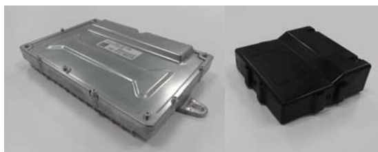
3 自動運転制御ユニット（左）、OTA制御ユニット（右）
