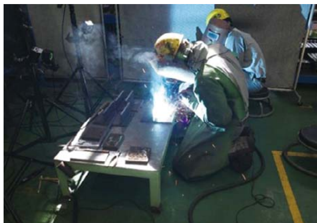
溶接作業の計測状況
