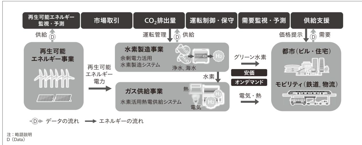
電気・熱を高収益かつオンデマンドに取引運用することをめざす。プラットフォームには、再生可能エネルギー監視、市場取引、CO<sub>2</sub>排出量モニタリングといったリアルタイムIoT (Internet of Things) 機能を組み込む。再生可能エネルギー電力や熱電エネルギーの需給データをリアルタイムに監視・予測し、各設備を制御して稼働タイミングを最適化することにより、安価な水素製造を可能にする。また、熱、電気、ガスの供給事業では、電気および熱の安価な生産が可能になり、市場価格に合わせて収益が得られる取引運用のサポートをめざす。都市、工場、モビリティ事業の需要家に向けては、従来より安い価格で電気、熱、グリーン水素をオンデマンドで入手可能な運用をめざす。既存の技術に加え、新たに水素技術を導入した際の全体のエネルギー・システムの経済性、環境性を両立するために、ドイツ連邦共和国のフランツホーファー研究機構太陽エネルギー研究所とグローバルに連携したトータルエネルギー・シミュレーションを進めている。欧州の典型モデルにおいて、再生可能エネルギー
