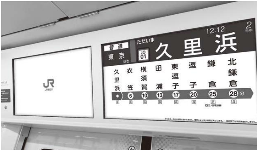
図1| 東日本旅客鉄道 E235系横須賀線 ドア上に設置された車内案内表示器
