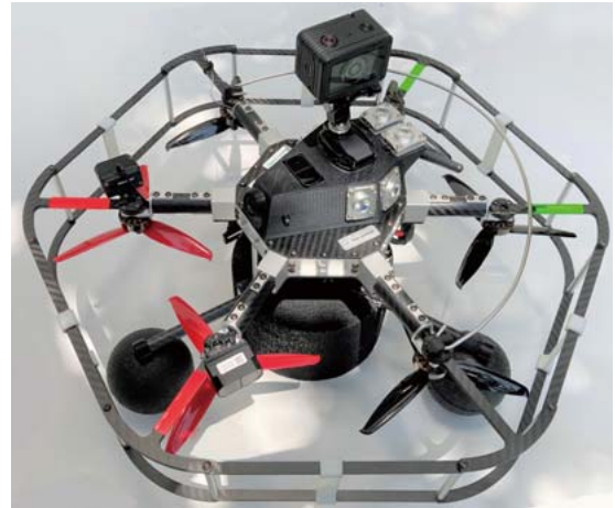
■ 下水管点検用ドローン外観
