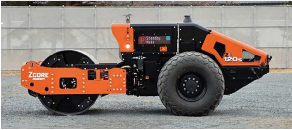
5 振動ローラ自律転圧システム本体
