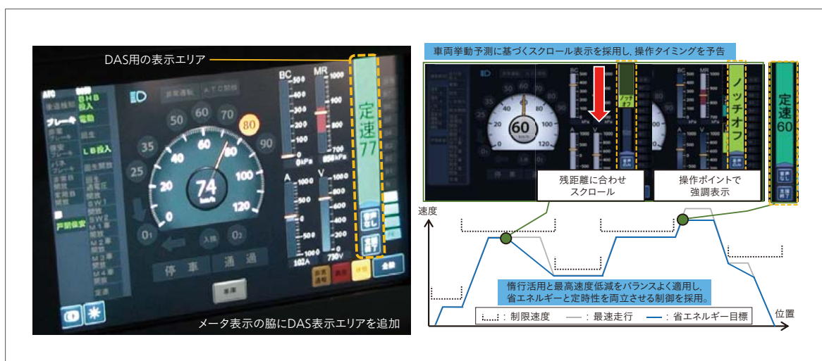
6 東京モノレール10000形の運転台画面におけるDAS表示例(左)とDASによる推奨運転操作の支援例(右)
