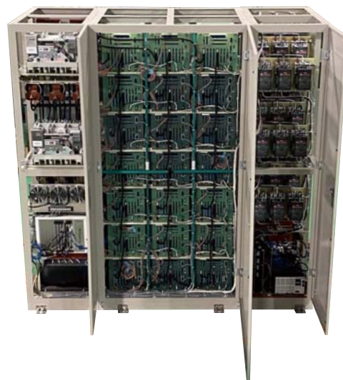
1 開発した350 kWマルチポートEV充電システムの外観
