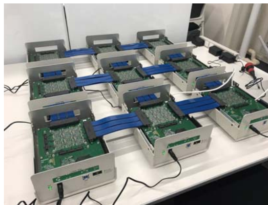
6 9ボード接続1.3 Mbit CMOSアニーリングプロトタイプ
