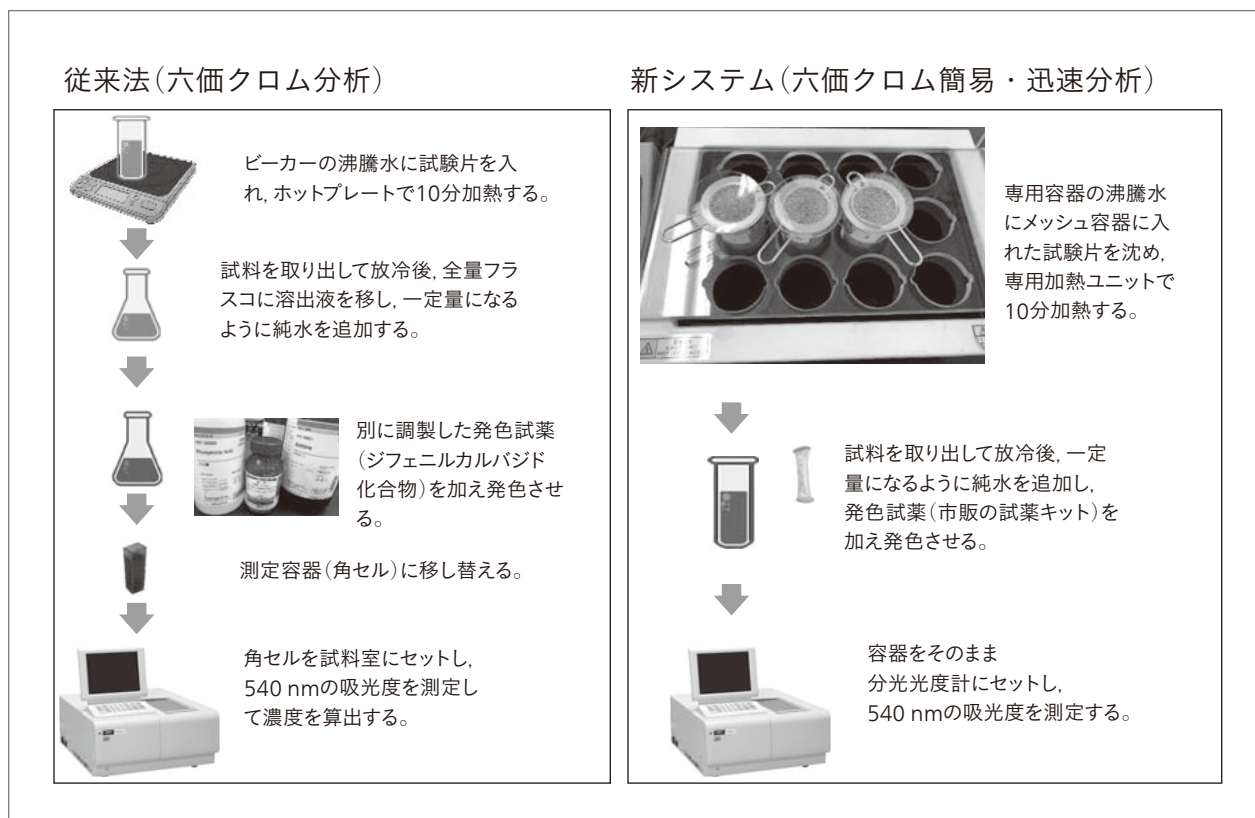
図4 IEC62321-7-1「金属試料の無色および着色防食皮膜中の六価クロムの確認試験」に基づく分析手法(従来法)と新システムの分析手順
