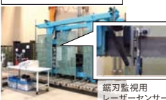
切断状況センシングによる遠隔監視・自動切断
