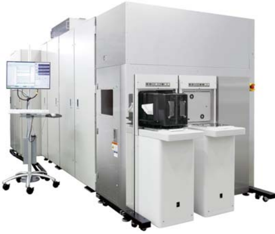
2 電子線広視野検査システムGS1000の外観
