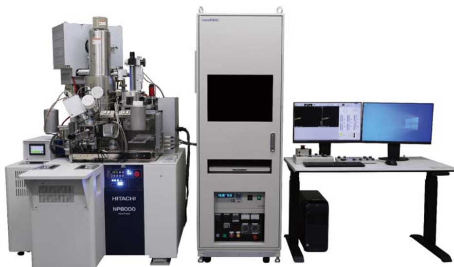
4 微小デバイス特性評価装置ナノ・プローバNP8000の外観
