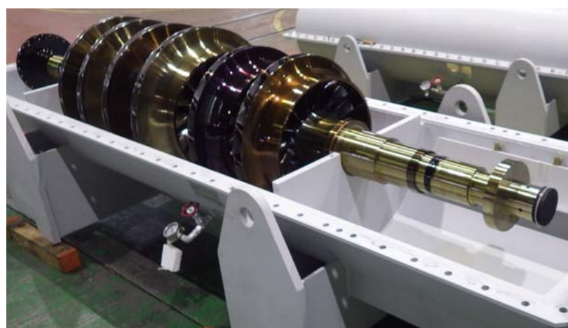
3 羽根車流路トリミングによる風量増加改造を実施した予備ロータ
