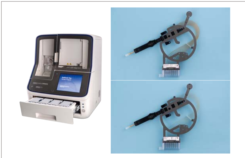
2 中型キャピラリーDNAシーケンサーSeqStudio Flex24ch装置本体(左)とキャピラリアレイ(24ch)(右上)、キャピラリアレイ(8ch)(右下)
