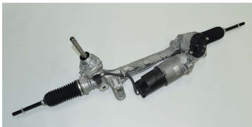
3 デュアルピニオン式電動パワーステアリング
