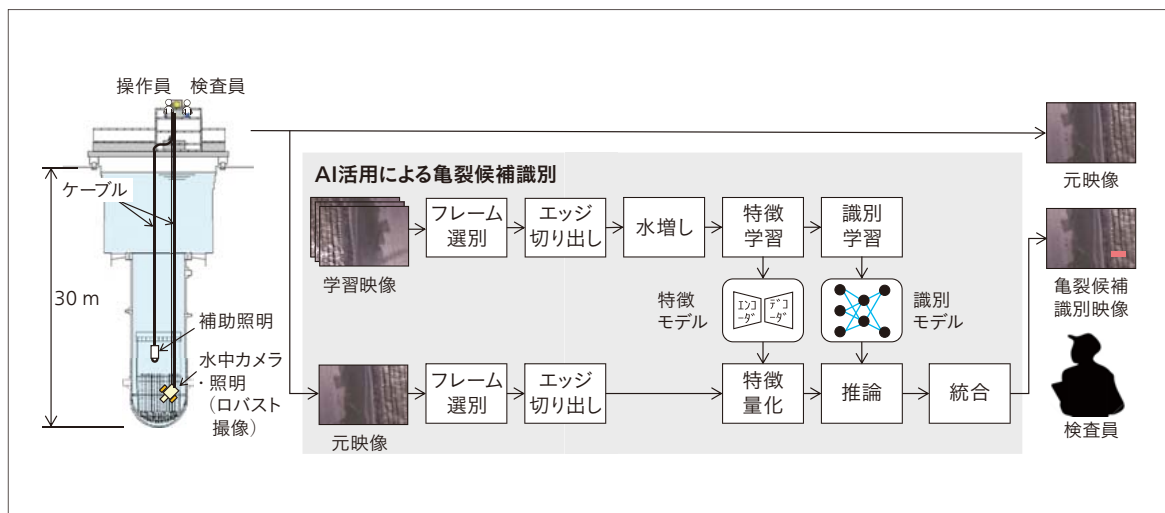
2 ロバスト撮像とAIを用いた炉内遠隔目視試験システム
