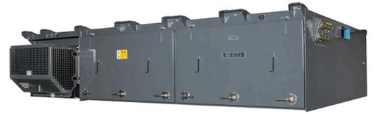
VVVFインバータとSIVを一体とし、小型化を図った。燃料電池を含めたハイブリッドシステム全体の制御を司る。
