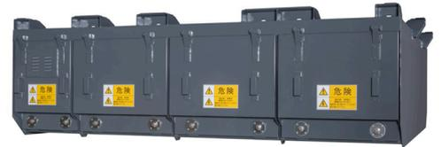
1箱で120 kWhの容量を持つ。Mzc車に2箱 (2群分) 設置されており、回生電力の回収および力行時、SIVの負荷急変時に電力を供給する。
