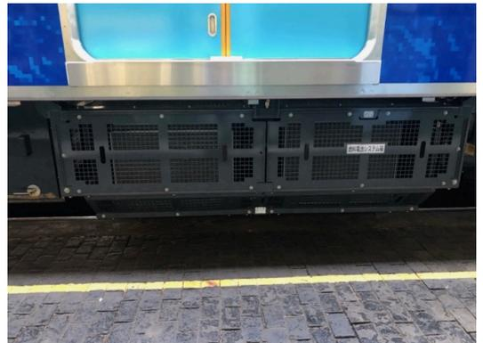
1箱に60 kWモジュールを2台備える。Tzc車に2箱（2群分）設置されており、水素を燃料として車両のベース電力を生み出す。
