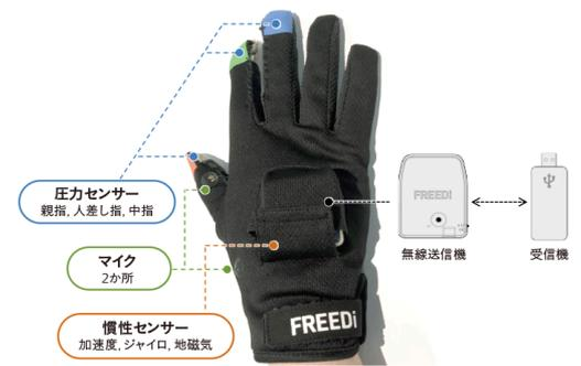
指先に取り付けられた圧力センサーにより指先動作を、手の甲部に取り付けられたジャイロセンサーにより手全体の動きをそれぞれセンシングする。センシングしたセンサーデータは無線送信機を介して受信機へと送られる。
