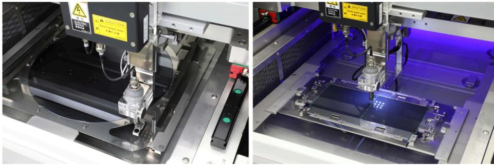
口径300 mmのウェーハ（左），JEDEC（Joint Electron Device Engineering Council）規格トレイを設置した状態のFineSAT7の水槽の外観（右）を示す。
