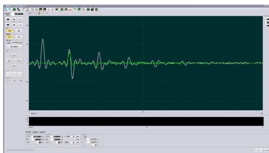
波形シミュレータのGUI（Graphical User Interface）画面を示す。積層構造の被検体の予測波形データを白いラインで表示している。色付きのラインは、1層目のチップから生じたエコーのハイライト表示である。
