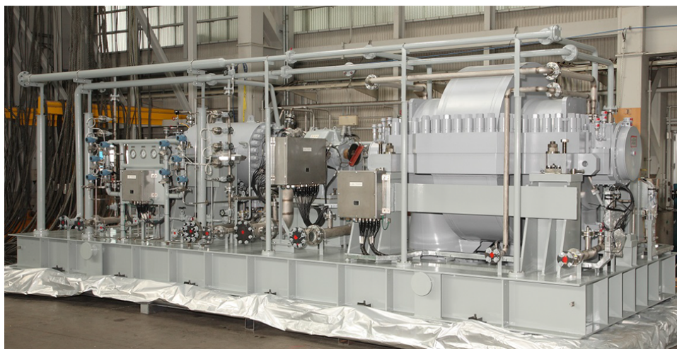
図3 | CO 2 圧縮機外観
