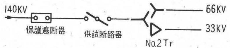
第5圖 勵磁電流試験回路
