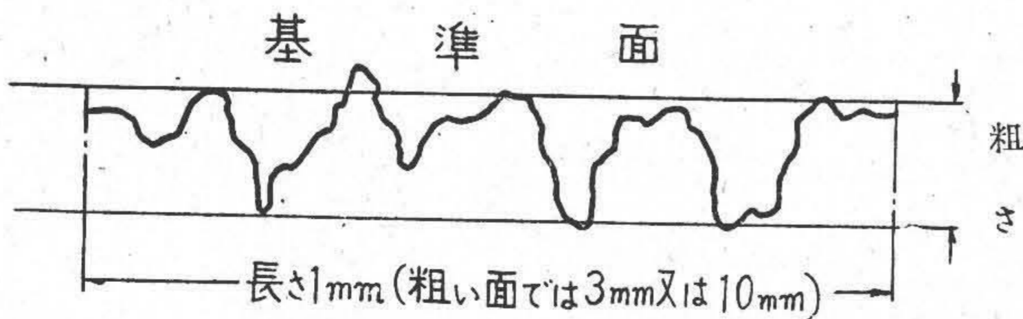
第2圖 觸針法に依る粗さ測定法 (JES 機械 0601)
