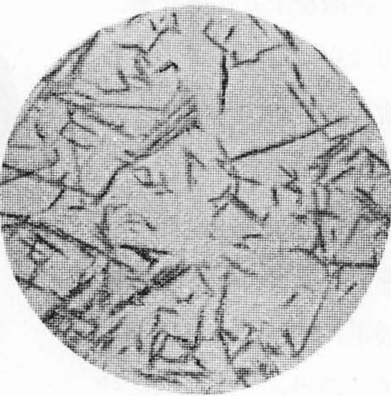
第 19 圖 C 試料 350°C 15 分恒溫變態 Fig. 19 C Specimen Austempered at 350°C for 15 Minutes
