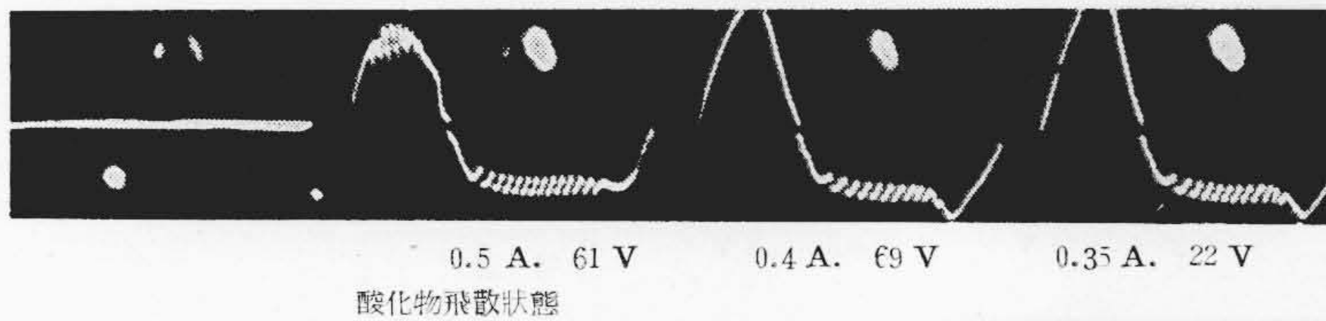
第 24 圖 電弧電壓波形 (酸化物崩解のときの波形其の一) Fig. 24 Wave Forms of Arc Voltage. (in Disintegration of Oxide Cathode. I)
