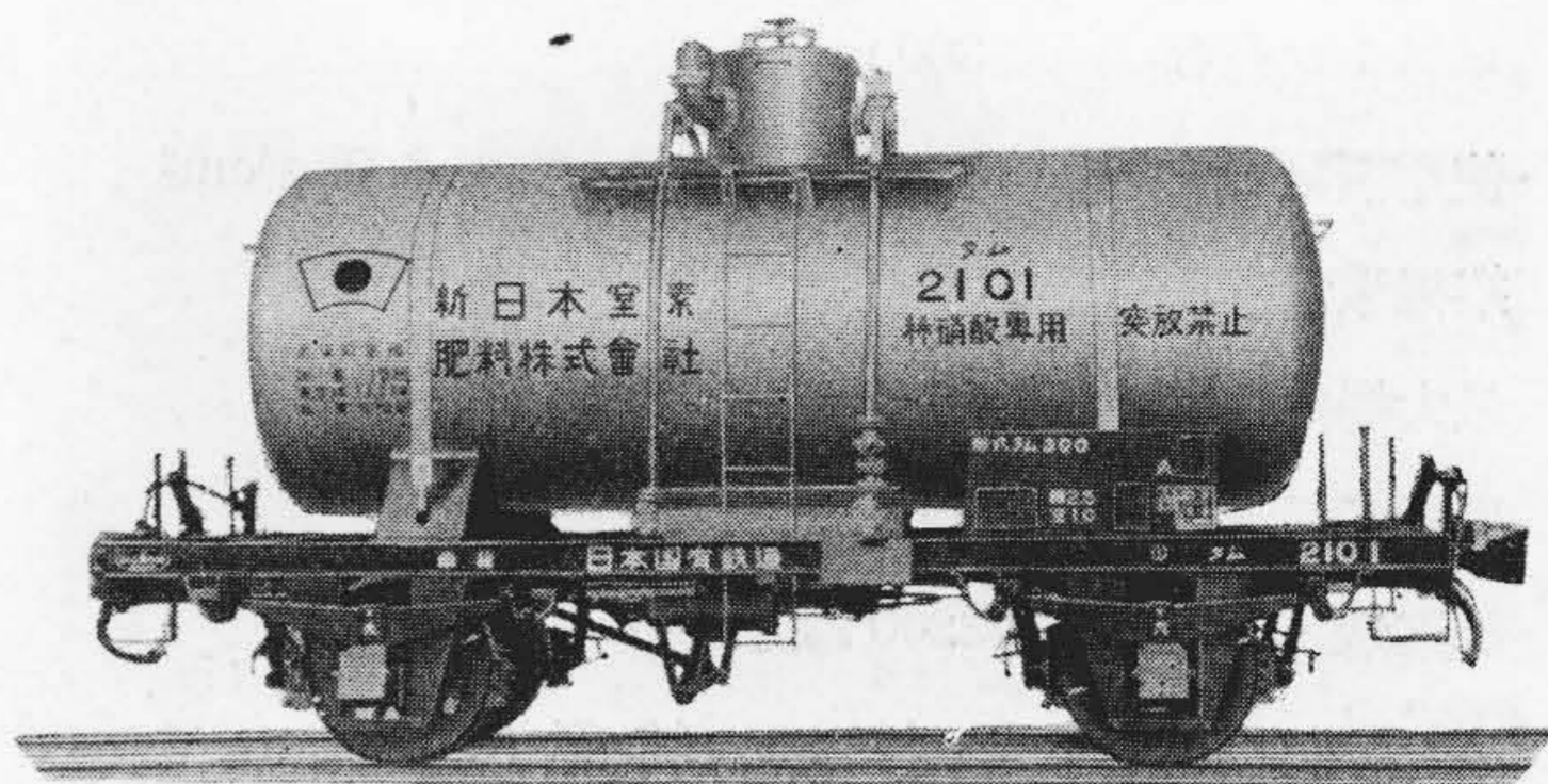
第 15 圖 15 t 積稀硝酸タンク車 Fig. 15 15 t Dil. Nitric Acid Tank Car. (18-8 Stainless Tank)
