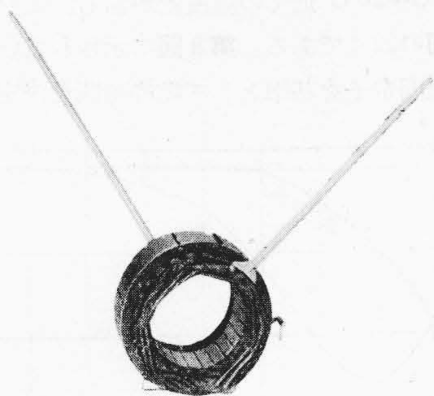
第3図 巻線温度測定 Fig. 3. Temperature Measurement diagram of Winding
