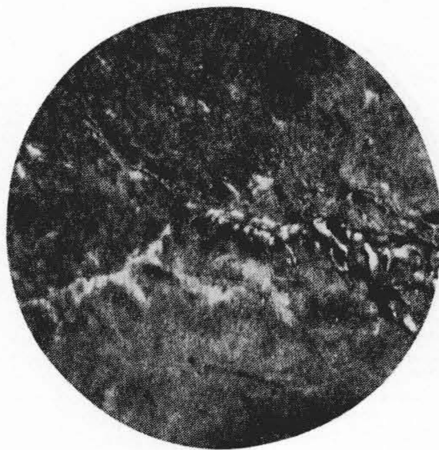
第 12 図 サルファークラックの P.D. etching 組織 (×100) Fig. 12. P.D. Etching Structure around Sulphur Crack
