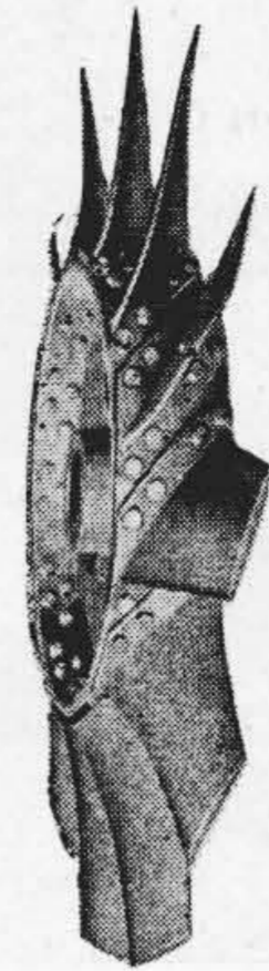
第5図 札幌鉄道局納 2,100 mm プロペラファン 用ランナ
