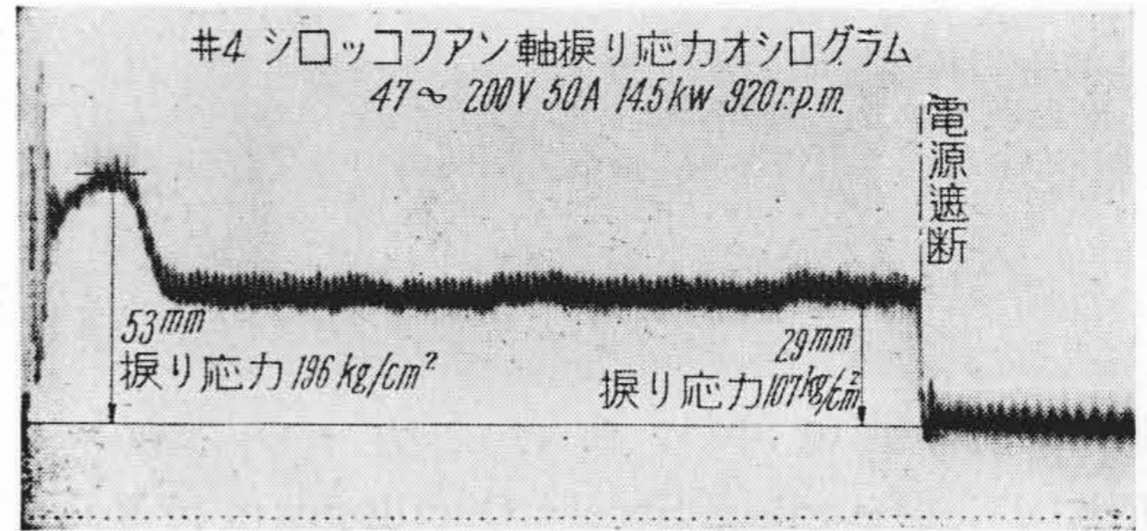
第 15 図 振り応力オッシログラム (起動から定常運転迄)
