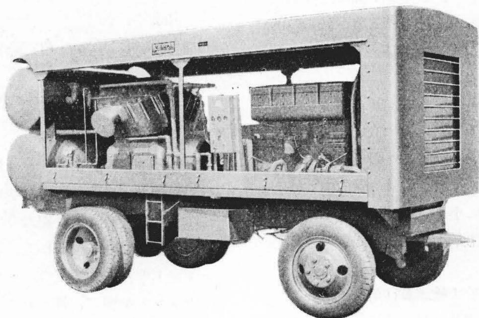
80 HP デイゼルエンジン駆動可搬式空気圧縮機
