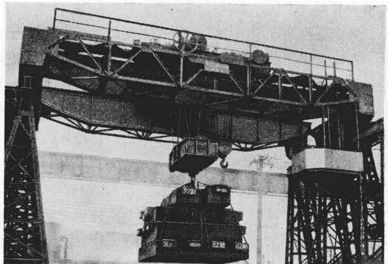
第 2 図 100/20 t × 11.5 m 天井起重機 Fig. 2. 100/20 t × 11.5 m Overhead Travelling Crane
