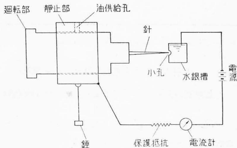
本発明は電流によつて油潤滑の場合の金属磨耗試験をするために、試験機の廻転を全然停止することなく、極めて容易に、しかも非常に短時間に磨耗状況を知り得る効果がある。
