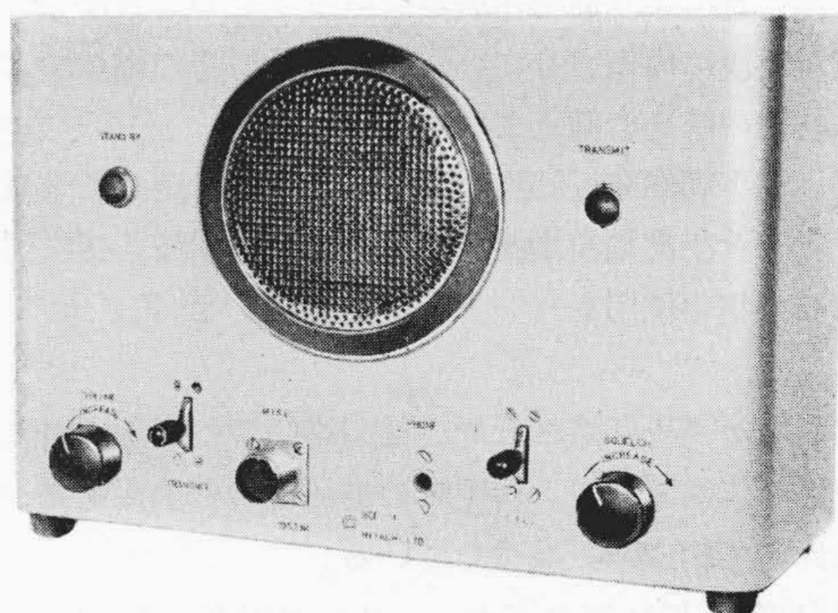
第 8 図 SCF-1 型固定局用制御器外観図 Fig. 8. Type SCF-1 Fixed Station Controller
