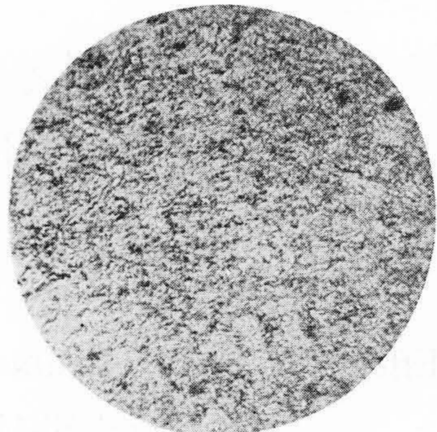
第3図 焼入焼戻処理したもの 880°C 油冷 320°C 焼戻 SMnC 90 Rc 48.5
