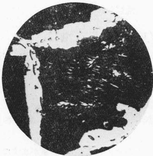
第 7 図 1,200°C から 650°C に 1 時間恒温処理後空冷された試料 B-6 (B 0.003%) の顕微鏡組織
