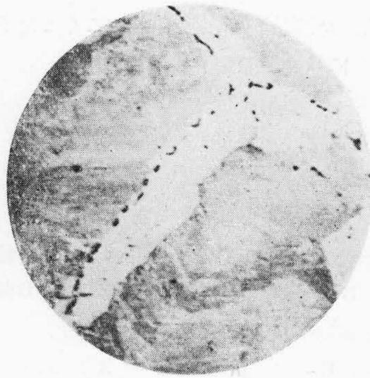
第 8 図 1,200°C から 650°C に 1 時間恒温処理後空冷された試料 B-6 (B 0.003%) の顕微鏡組織
