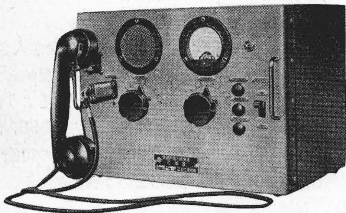
第 2 図 PTB-2 型保線用電力線搬送電話装置 Fig. 2. Type PTB-2 Power Line Carrier Telephone Equipment
