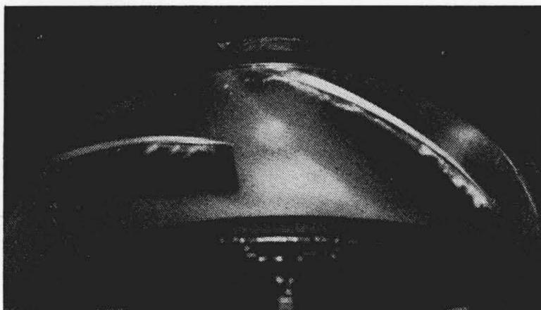
第12図 6枚羽根ランナによるキャビテーション試験ストロボ写真
