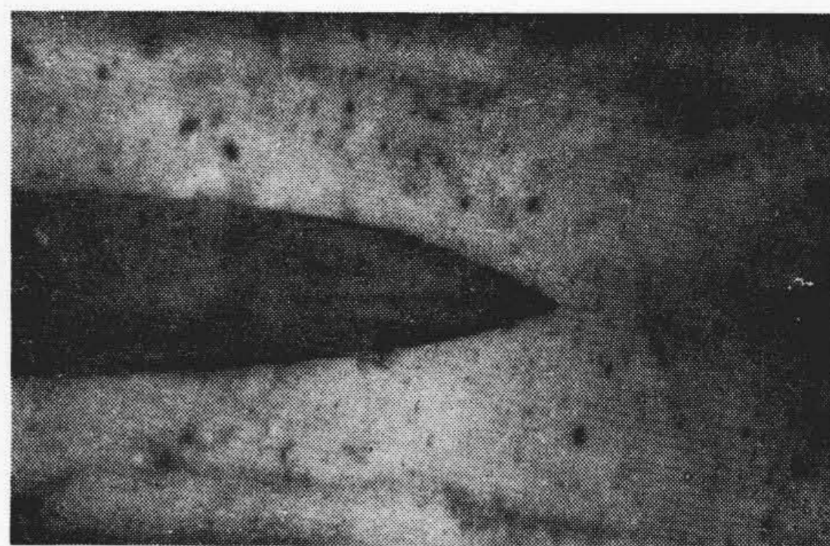
第1図 押出式プラストメータのオリフィス内の合成ゴム(ネオプレンW)の形状 荷重 47.6 kg/cm 2
